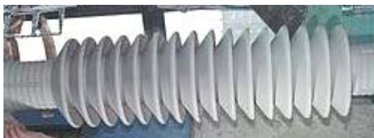
Fig. 3. Izolator de înaltă tensiune în cursul fabricării, înainte de stratul final de smalț
